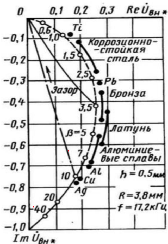
Рисунок 2.6 Годограф для розрахунку внесених напруг
