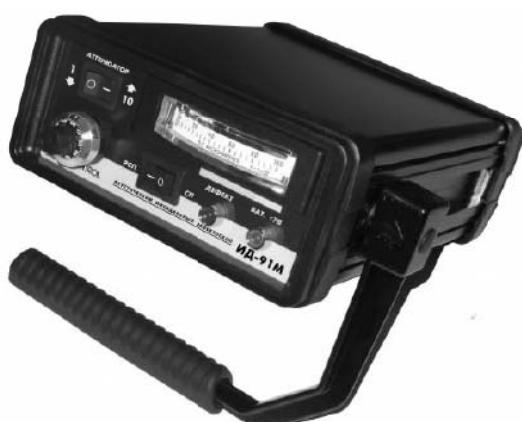
Рис 1.16 Зовнішній вигляд дефектоскопу ИД-91М
