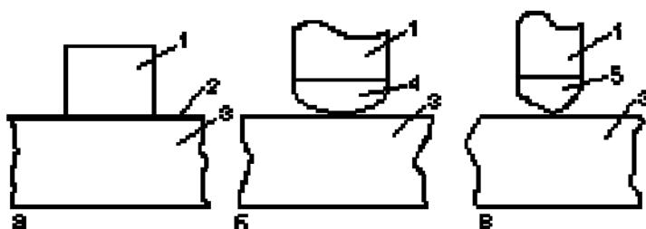
Рис.2.4 Види контакту перетворювачів імпедансних приладів з контролльованими об'єктами: 1 – перетворювач; 2 – шар рідини; 3 – контролльований об'єкт; 4 – контактний наконечник з сферичною робочою поверхнею; 5 – контактний наконечник (індентор) з гострим кінцем
