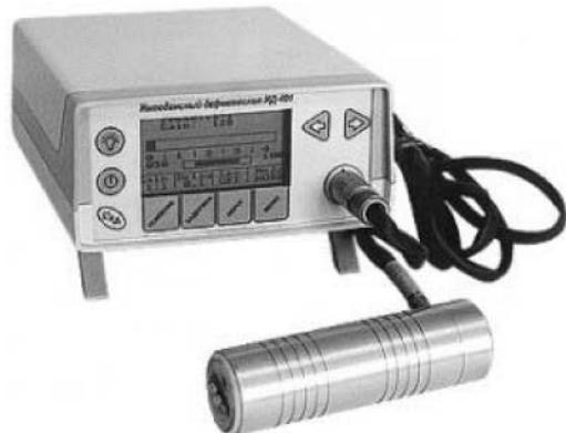
Рис 1.14 Зовнішній вигляд дефектоскопу ИД-401
