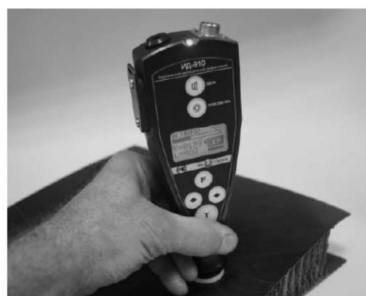
Рис 1.17 Зовнішній вигляд дефектоскопу ІД-910
