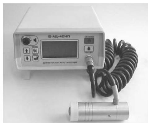
Рис 1.13 Зовнішній вигляд дефектоскопу АД-42 ИП
