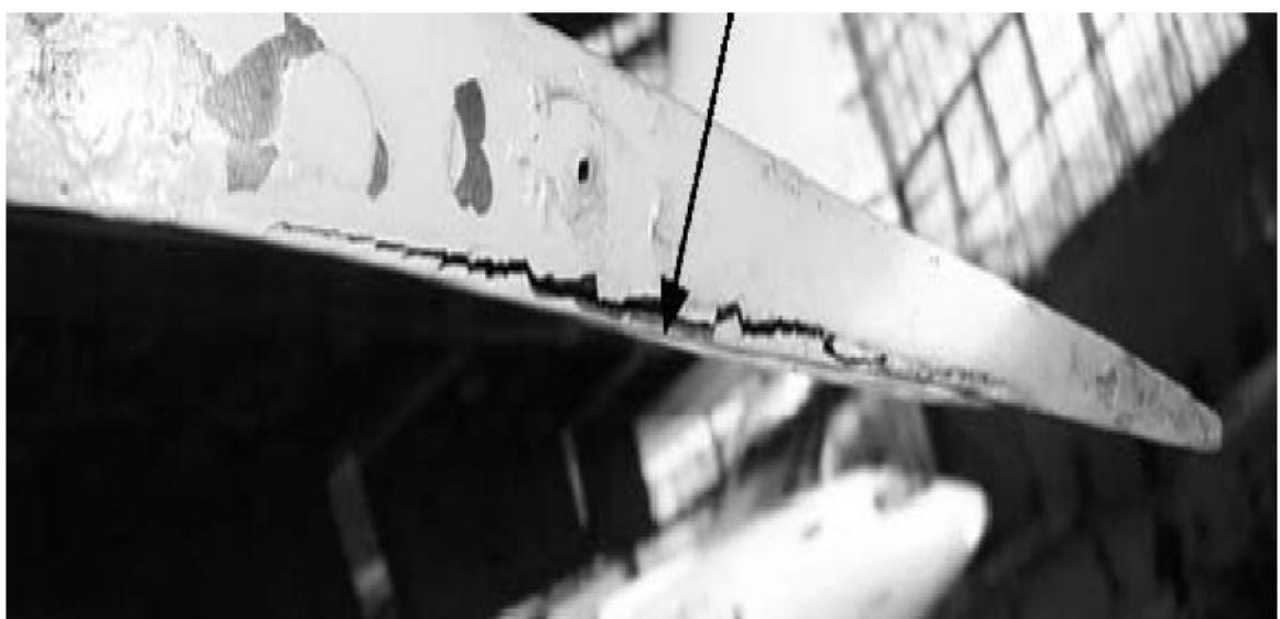
Рис.1.3. Приклад розшарування сотової панелі
