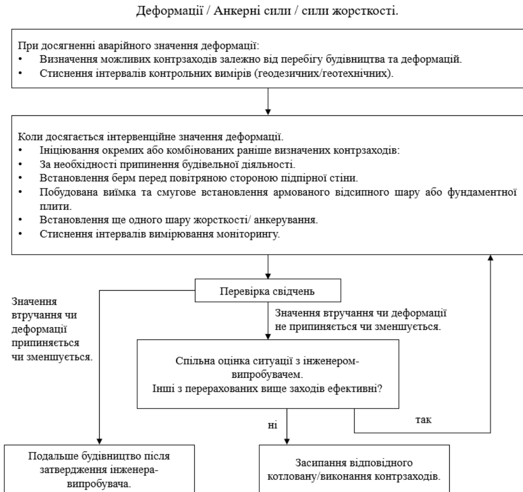
Рисунок 2.3.1 – Схема плану дій при досягненні аварійного значення деформації
