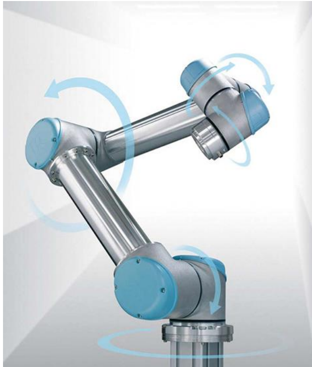
Рисунок 2 – Відображення ступенів свободи у робота-маніпулятора серії UR
