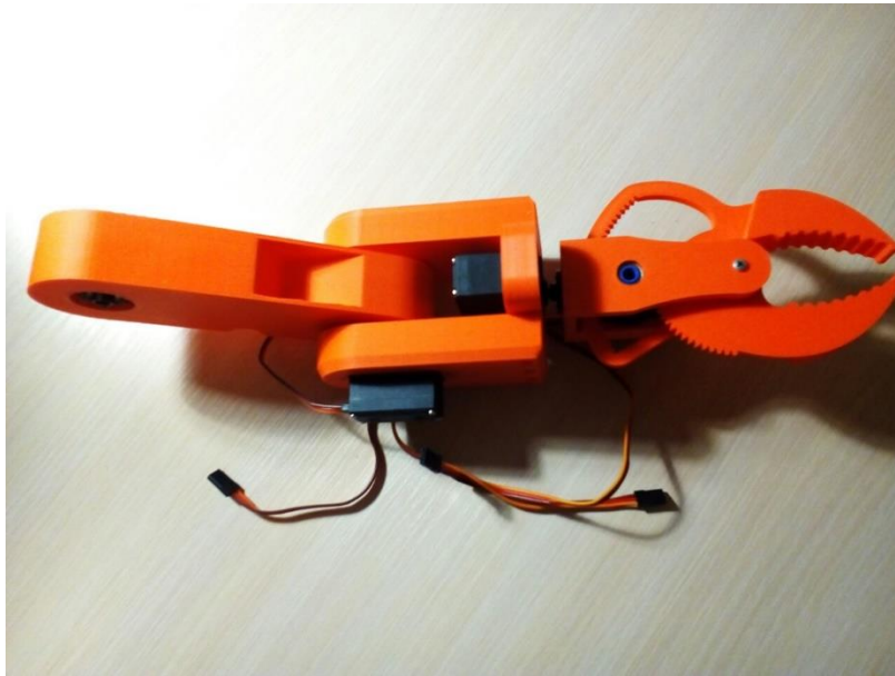
Рисунок 33 – Зона захвату з кріпильними елементами в зібраному стані
