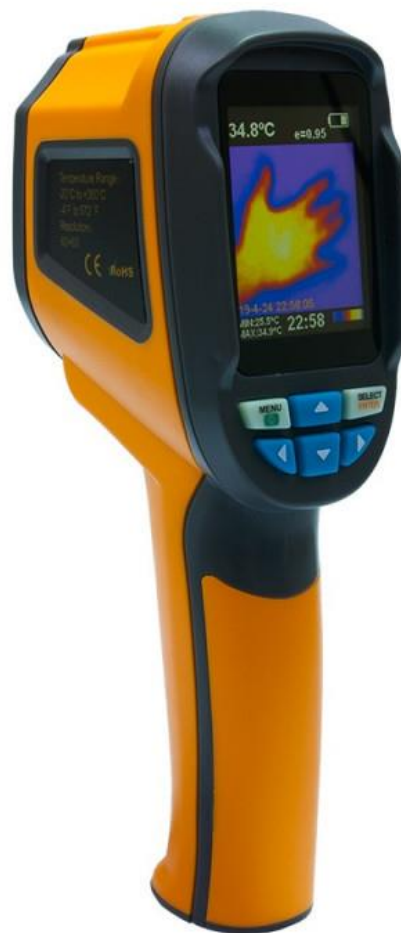
Рис. 1.7. Загальний вигляд тепловізора Xintest НТ-02
