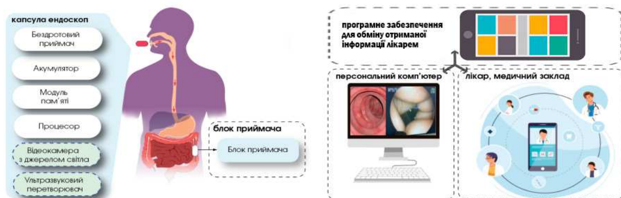
Рис.1. Принцип проведення капсульної ендоскопії
