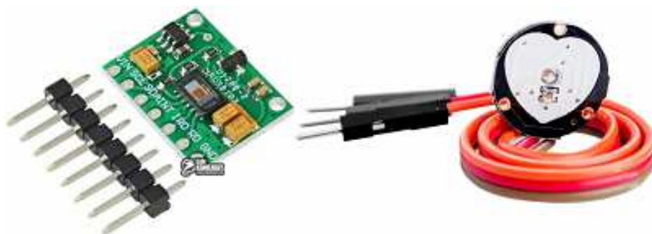
Рис. 2. Датчики венозного пульсу: а - MAX30102, б - Pulse sensor
