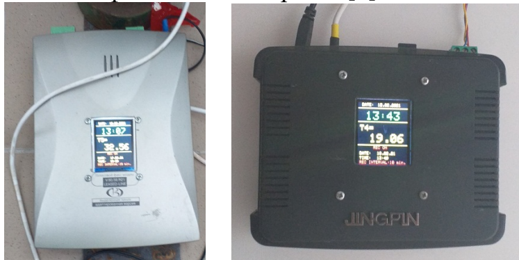
Рис. 2. Вторинні прилади для безперервного моніторингу значень температури на експериментальному стенді
