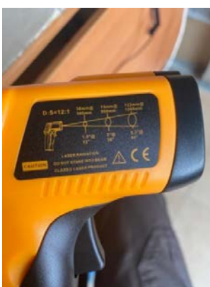
Рис. 1. Використовуваний пірометр та його характеристики
