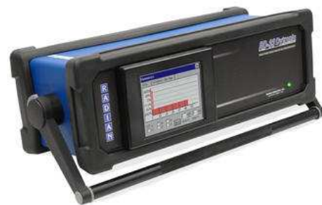
Рис. 2. Прецизійний трифазний еталонний лічильник електроенергії
