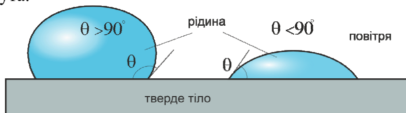
Рис. 2. Ілюстрація методу лежачої краплі для дослідження ККЗ
