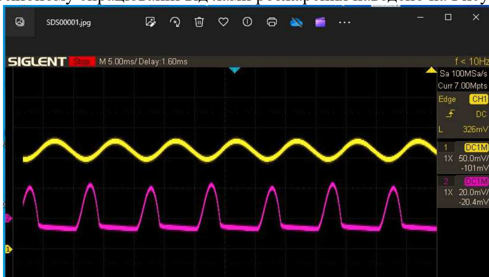
Рис. 3. Сигнал АО із модуляцією синусоїдою 100 Гц (канал 1 – жовтий)
