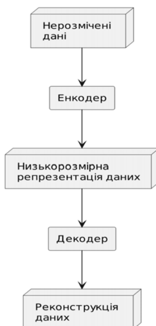
Рис. 1. Процес тренування енкодера та декодера
