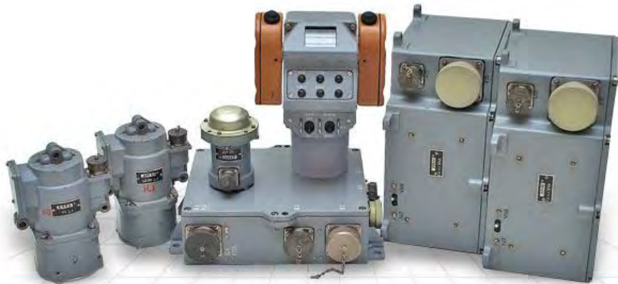
Приладовий комплекс стабілізатора озброєння СВУ500-4Ц
